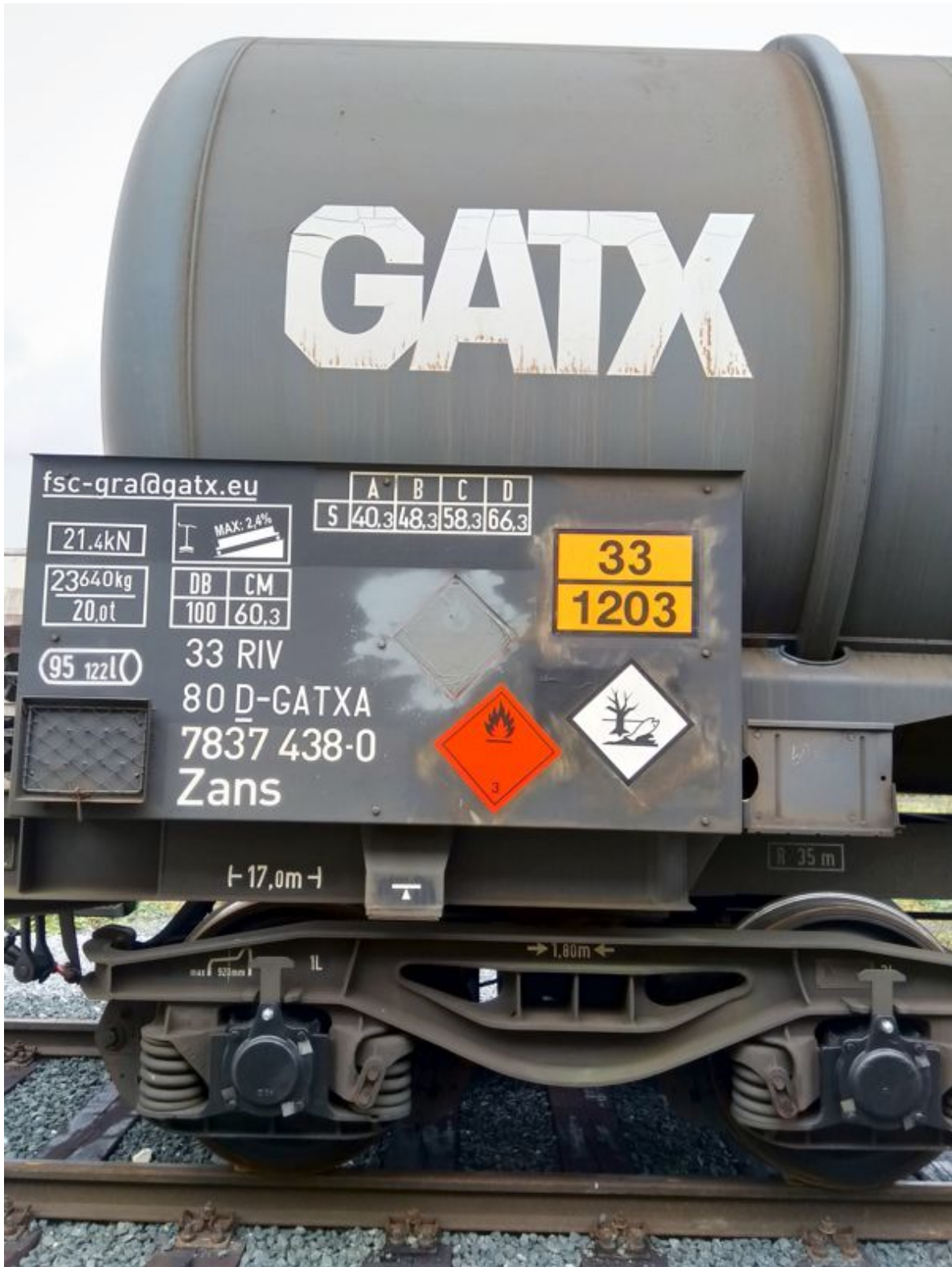
GATX-Waggon – feuergefährlich, zerstört die Umwelt
